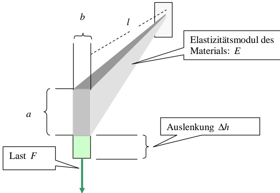
Abbildung 13 Biegung eines einseitig eingespannten Balkens: Die Höhe  $a$  geht mit 3. Potenz in die Auslenkung  $\Delta h$  ein.
