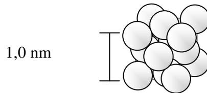
Abbildung 9 Modell starrer Kugeln für ein kubisches Metallgitters (z. B. Al, Fe, Cu, Au), dichteste Kugelpackung: Jede Kugel wirkt auf alle Nachbarn anziehend.
