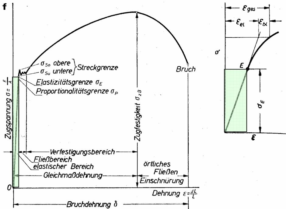
Abbildung 12 Bereiche der Dehnung im Festkörper. Im Einsatz rechts ist  $\epsilon_{el}$  die elastische,  $\epsilon_{bl}$  die bleibende Dehnung (Aus Netz, Formeln der Technik, 2. Auflage). Grün: Bereich der Gültigkeit des Hookeschen Gesetzes.
