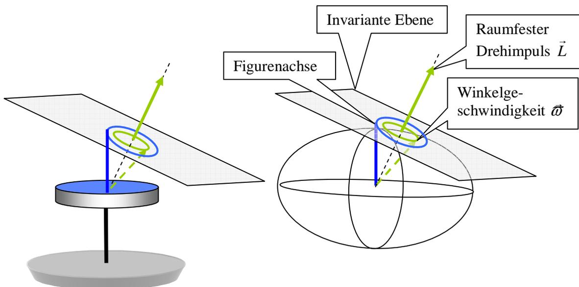
Abbildung 6 Nutationsbewegung eines im Schwerpunkt gelagerten Kreisels: Die Drehachse liegt außerhalb der Figurenachse. Die Figuren- und die momentane Drehachse laufen in Kreisbahnen auf der „invarianten Ebene“ um deren Normale, den invarianten Vektor  $\vec{L}$  des Drehimpulses: Das Trägheitsellipsoid rollt auf der invarianten Ebene ab.
