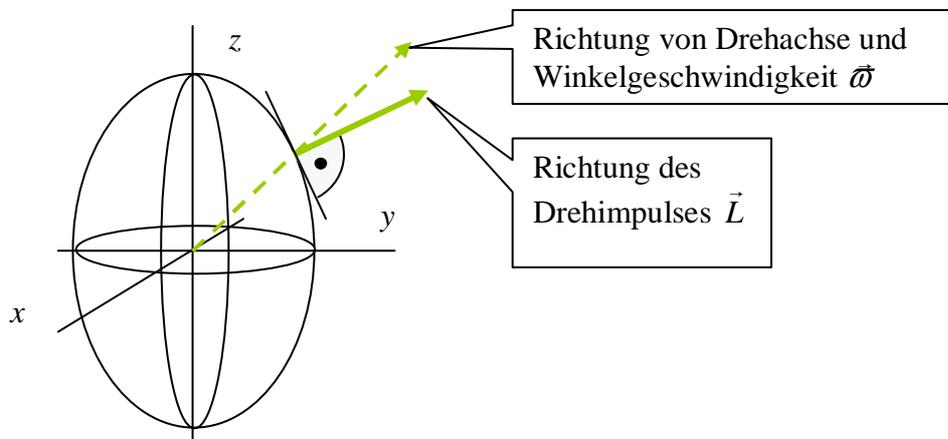
Abbildung 4 Poinsot Konstruktion zur Bestimmung der Richtung des Drehimpulses: Der Drehimpuls  $\vec{L}$  steht senkrecht auf der Tangentialebene. Diese „invariante Ebene“ tangiert den Trägheitstensor im Durchstoßpunkt von  $\vec{\omega}$ .
