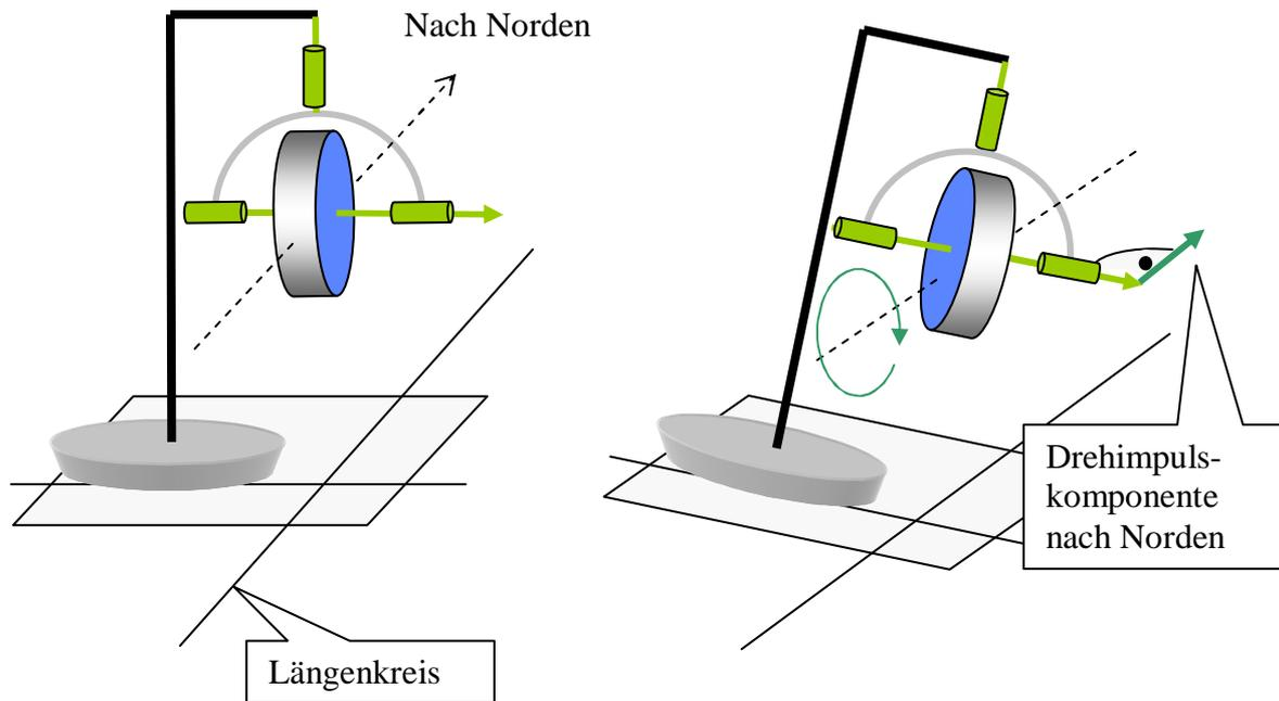
Abbildung 8 Der Kreiselkompass: Zwischen dem Bild links und rechts kippt die Erdrotation Kreiselachse um die strichlierte, von Süd nach Nord weisende Achse nach unten. Dieses Drehmoment verursacht eine nach Norden weisende Komponente zum Drehimpuls. Der Kreisel weicht diesem Drehmoment durch eine Präzessionsbewegung aus, bis die Kreiselachse in der strichlierten Achse liegt. Die freien Achsen und ihre Lagerungen sind grün gezeichnet.
