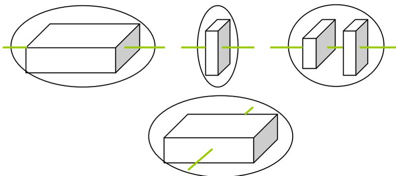
Abbildung 3 Schema der vier Jo-Jo Aufbauten mit den dazugehörigen Trägheitsellipsoiden. Die Achse der Rotation liegt in den Konstruktionen links in Richtung des größten bzw. des kleinsten Trägheitsmoments, rechts sind alle Achsen gleichberechtigt: Das Jo-Jo läuft stabil. Darunter: Rotation um die mittlere Achse des Trägheitsellipsoids: Das Jo-Jo läuft instabil.
