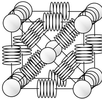
Abbildung 10 Die elastischen Wechselwirkungskräfte zwischen den Teilchen eines Kristall - Gitters können als Federkräfte zwischen den atomaren Teilchen modelliert werden. Für kleine Auslenkungen gilt das Hookesches Gesetz. ( Zur besseren Übersichtlichkeit wurden - im Vergleich zum atomaren Modell- einige Teilchen weggelassen).
