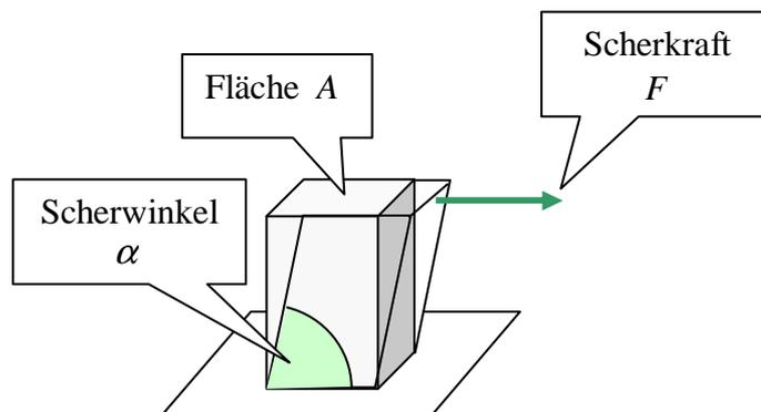
Abbildung 14 Scherspannung an einem quaderförmigen Körper, an dessen oberer Fläche eine Kraft angreift.
