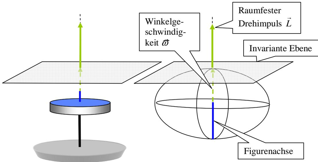
Abbildung 5 Kreisel und Trägheitsellipsoid bei Drehung um die Achse des größten Trägheitsmoments. Die Richtung der Winkelgeschwindigkeit zeigt die momentane Drehachse.
