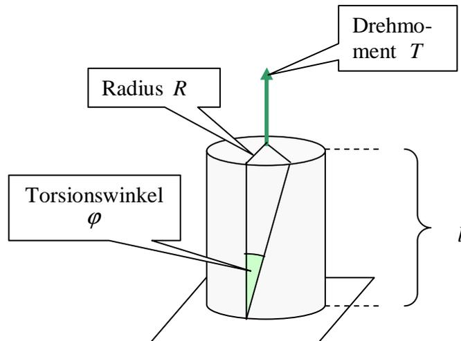
Abbildung 15 Torsion eines zylinderförmigen Körpers, an dessen oberer Fläche ein Drehmoment wirkt.
