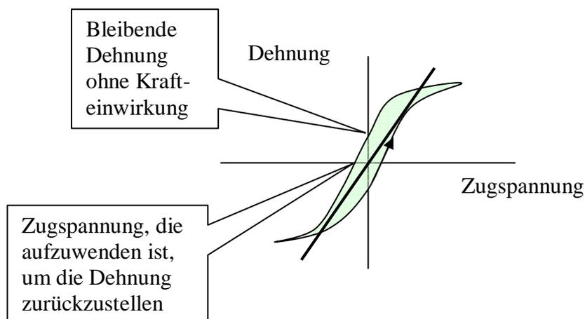
*Abbildung 16 Elastisches (stark gezeichnete Gerade) und Hysterese Verhalten. Die Fläche im Bereich der Hysterese Kurve ist ein Maß für die bei einem Zyklus aufgewendete Arbeit. Die Hysterese Kurve beginnt nur bei der ersten Auslenkung im Ursprung.*
