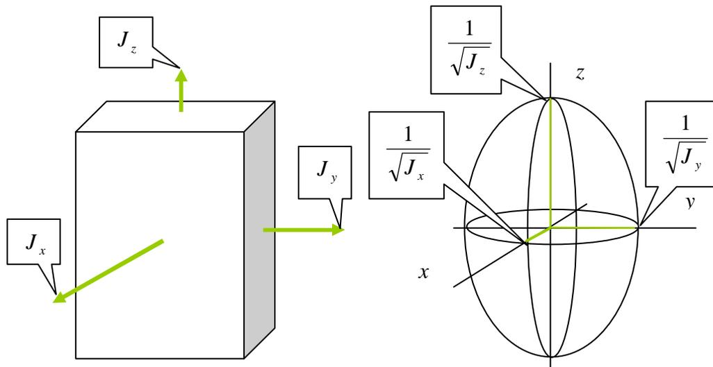
Abbildung 2 Drehimpulse (gelbgrüne Pfeile) in Richtung der Hauptträgheitsachsen und Trägheitsellipsoid für einen Quader. Nur die Richtungen  $x$  und  $z$  des größten und kleinsten Trägheitsmoments sind mögliche Achsen für stabile, freie Rotation.
