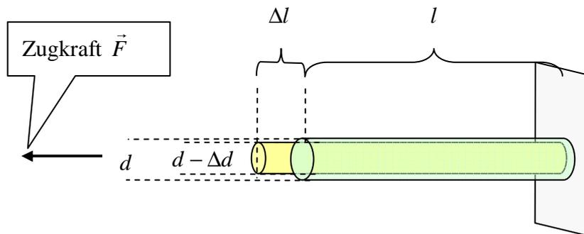
Abbildung 11 Dehnung eines Stabes mit Querschnitt A
