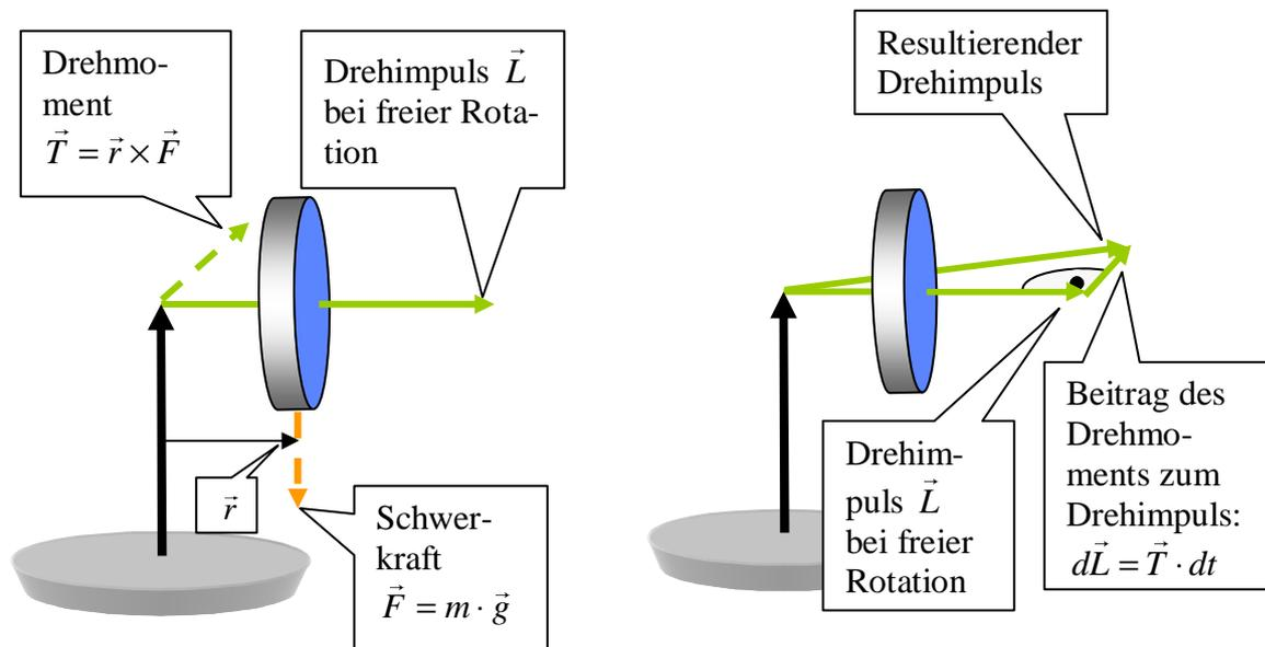
Abbildung 7 Zur Präzession des Kreisels. Links: Ein Kreisel sei im Schwerfeld im Abstand  $r$  vom Schwerpunkt gelagert, der Drehimpuls sei  $\vec{L}$  (grün). Rechts: Die Schwerkraft (orange) erzeugt ein Drehmoment (grün strichliert). Rechts: Drehimpulse in Folge der links gezeigten Kraftwirkung.
